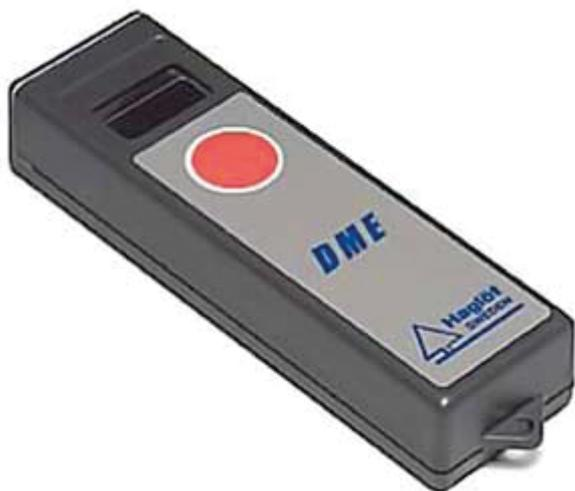
Для измерения расстояния используются ультразвуковые импульсы.
