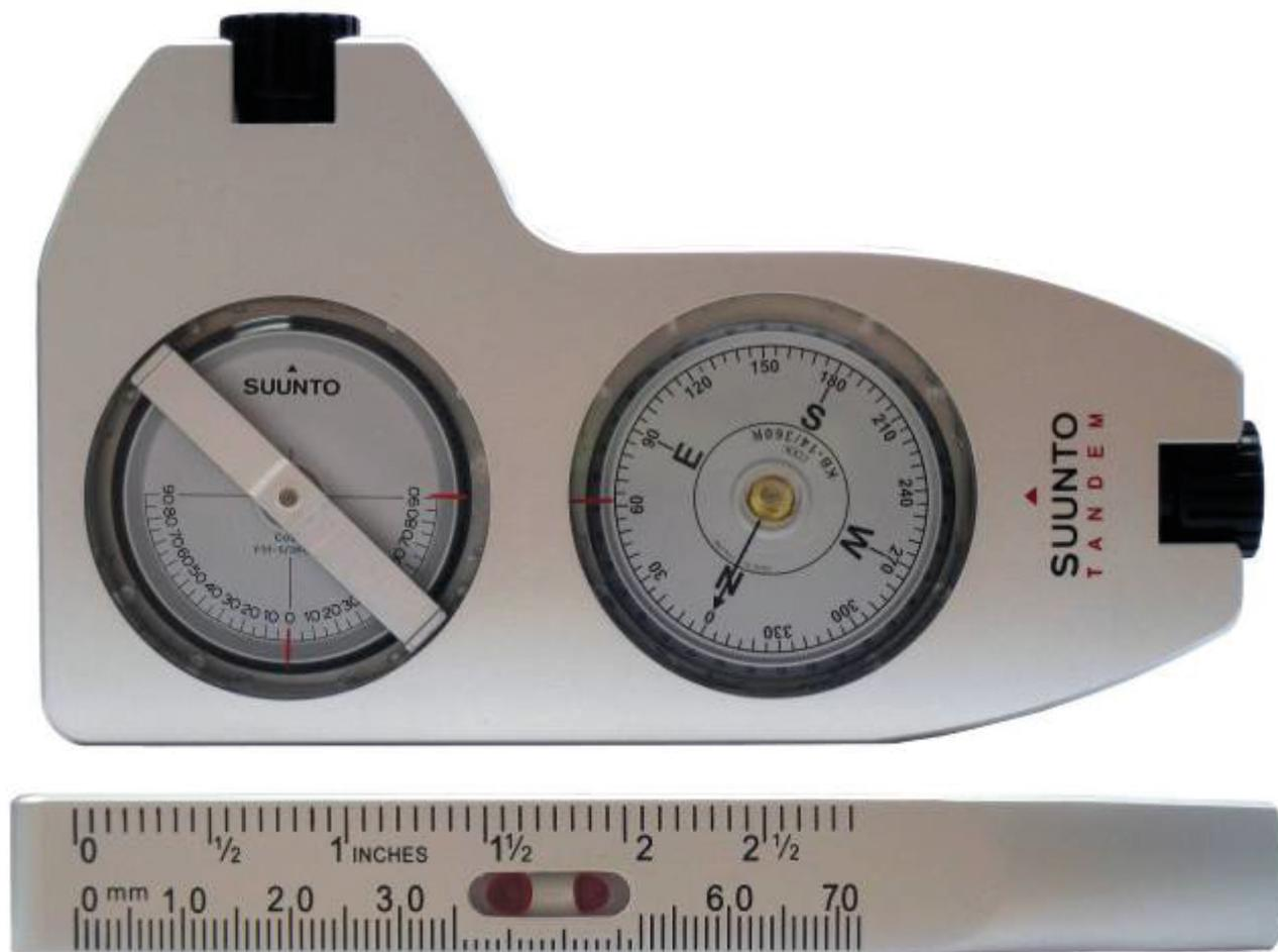
Suunto Tandem представляет собой два инструмента для точных измерений, объединенных в одном корпусе — буссоль и клинометр.
