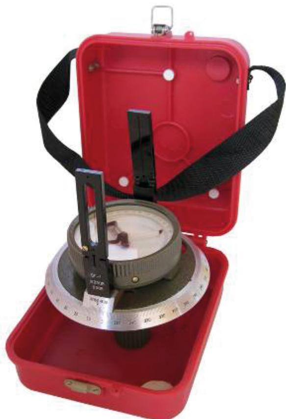
Буссоль БГ-1 предназначена для измерения румбов и азимутов направлений, горизонтальных углов на геодезических полигонах, а также при проведении различных лесоустроительных, топографических и инженерно-геодезических работ.
