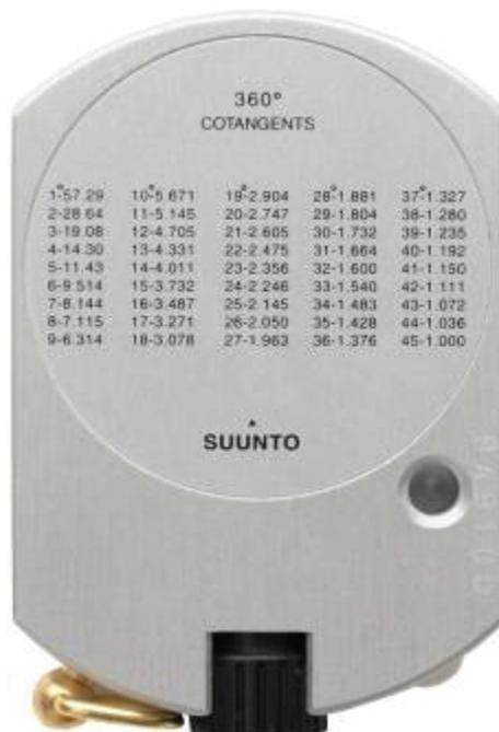
Буссоль Suunto KB-14 — превосходный инструмент для лесников и геологов, используется для съемки границ и привязки лесосек, ориентирования на местности, измерения магнитных азимутов, построения горизонтальных углов. Применяется при проведении лесоустроительных — отвод лесосек и топографических работ.
